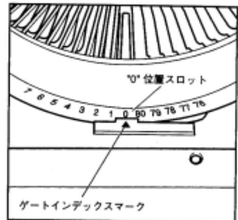
セレクトボタンを押すと、スライドトレイの回転はフリーとなります。また、スライド押し上げレバーが強制的にスライドマウントをゲートより押し上げます。セレクトボタンを押した状態でスライドトレイの“0”位置スロットがゲートインデックスマークに合う位置まで回し、その位置でスライドトレイを取り外してください。
