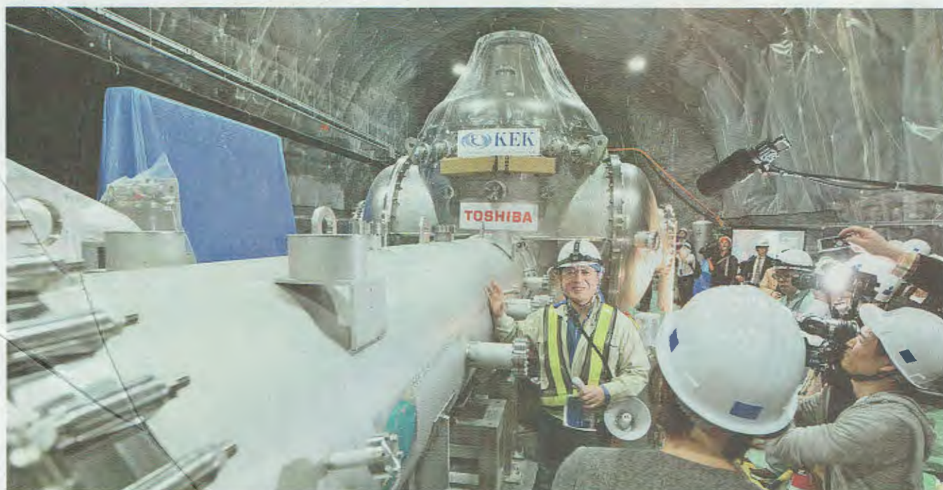
かぐらの目玉装置「クライオスタット」(中央)は、中のサファイア鏡をマイナス253度まで冷却し、鏡の熱振動を抑えます
