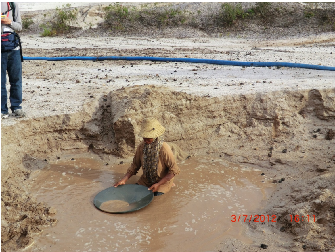
パンを使って微量の砂金を採取 Collecting a tiny amount of gold using a pan
