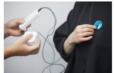
心臓ピクニック(鼓動記録再生提示装置)
