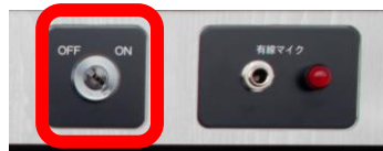
AV ラックキー差込口
