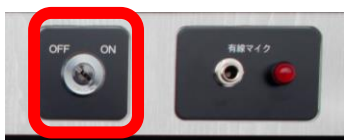
AV ラックキー差込口
